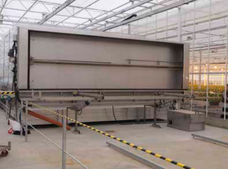
Fot. 10. Wysokociśnieniowa myjnia do stołów znajduje się w hali
