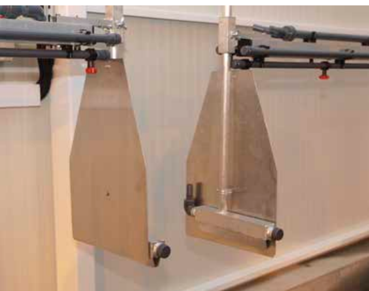
Fot. 12. Aluminiowe osłony zamontowane z boku „wylewek” ograniczają rozpryskiwanie się wody
