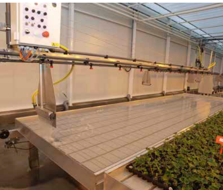
Fot. 11. Ważną funkcję pełnią samojezdne ramiona do napełniania stołów wodą, a także nawożenia ukorzenianych sadzonek i opryskiwania ich środkami ochrony roślin oraz regulatorami wzrostu
