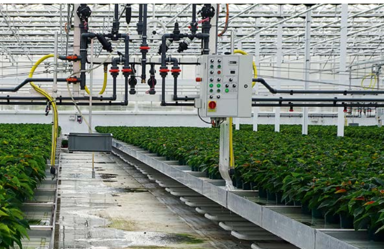
Fot. 6. Samojezdne belki nawadniające mogą dozować pożywkę na wybrane stoły
